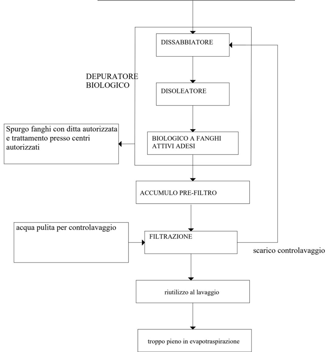
DIAGRAMMA DI FLUSSO APPROVVIGIONAMENTO IDRICO
